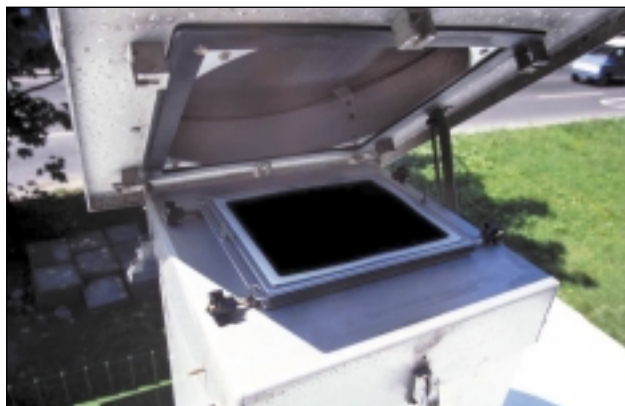
Sadza z powietrza zawiera dioksyny. Na zdjęciu zatrzymana na powierzchni płaskiego filtra sadza po przepuszczeniu 1600 m 3 powietrza atmosferycznego w Krakowie
