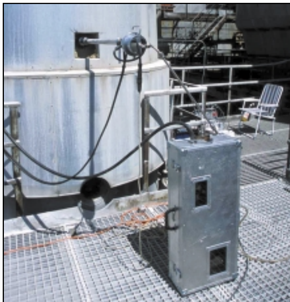
Aparatura do pobierania próbek spalin na zawartość dioksyn. Na zdjęciu przedstawiono pobór próbek spalin z komina pieca cementowego
